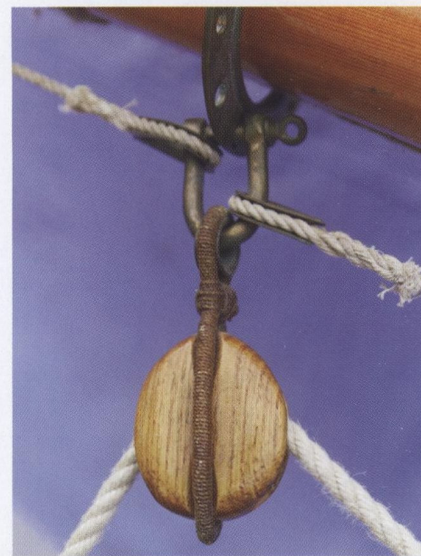
ANCORA UN'IMMAGINE DI VESPA. IL RESTAURO, IMPECCABILE DA UN PUNTO DI VISTA TECNICO, NON RISPETTAVA L'ARMO ORIGINALE. IN BASSO, IN SENSO ANTIORARIO, PARTICOLARE DELLE CAVIGLIE RACCOGLICIMA, UNA BITTA E UN BOZZELLO ORIGINALE.
